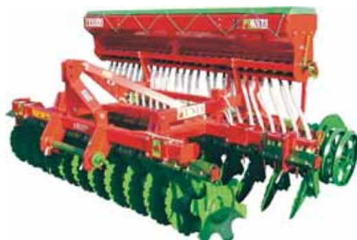
ALFA 3/550/25 zamontowana na agregacie ARES TXL.
