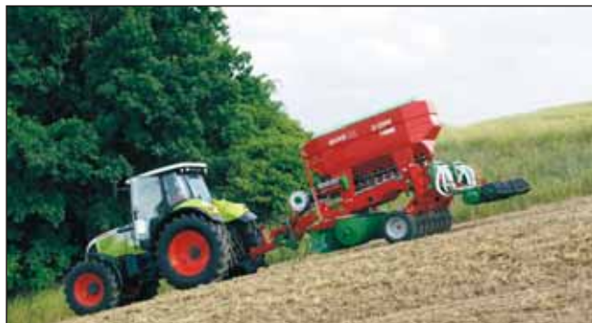
Quick 3/3200 (siew uproszczony, redlica jednotarczowa)
