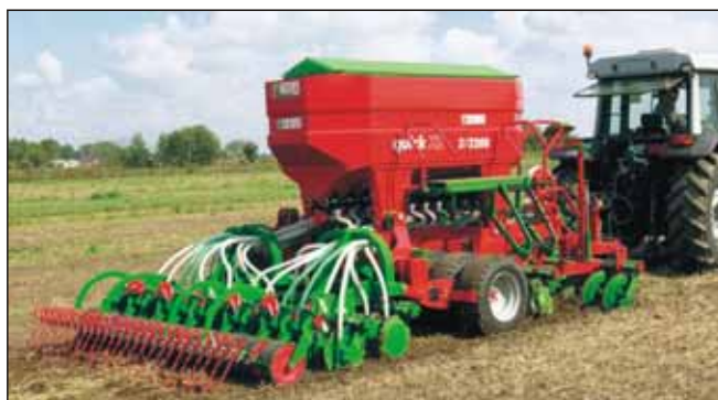
Quick 3/3200 (siew uproszczony, redlica jednotarczowa)
